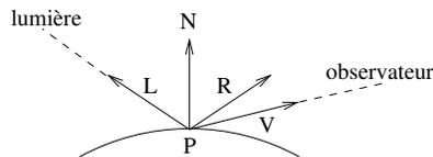
Etant donné une surface, un point  $P$  de cette surface, une source lumineuse et un observateur, l'intensité lumineuse apparente du point  $P$  pour l'observateur est donnée empiriquement par :
